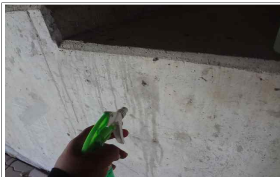
콘크리트 탄산화 시험
