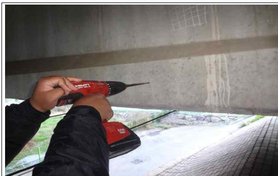
콘크리트 탄산화 시험
