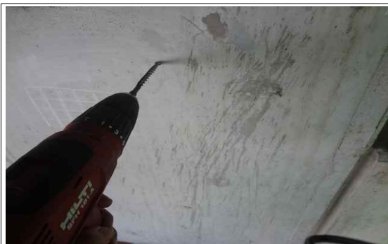
콘크리트 탄산화 시험
